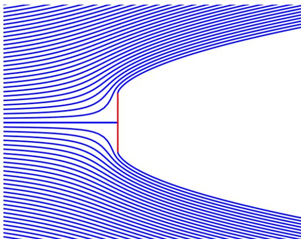
Figura 4: Flusso incomprimibile potenziale e stazionario attorno una piastra in due dimensioni
