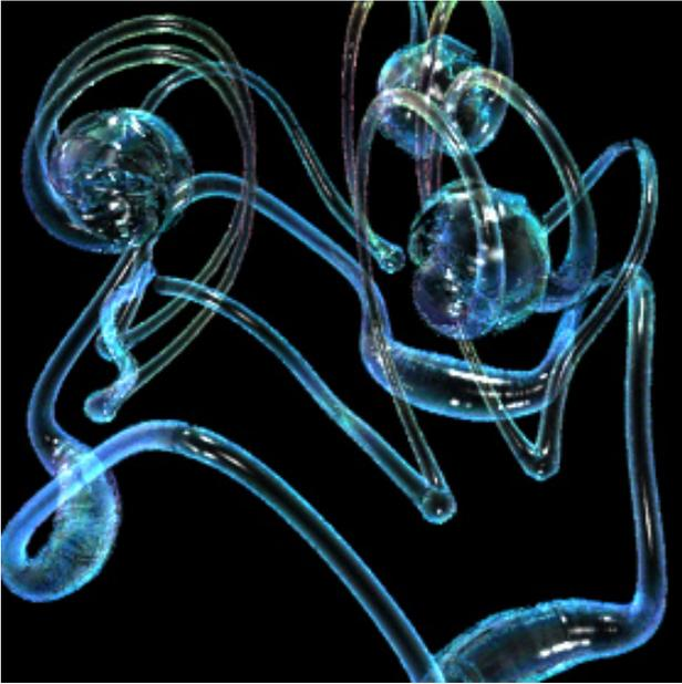
**Figura 8:** Screenshot di una simulazione di due filetti vorticosi leap-frogging modellati con un flusso potenziale ideale incomprimibile.
